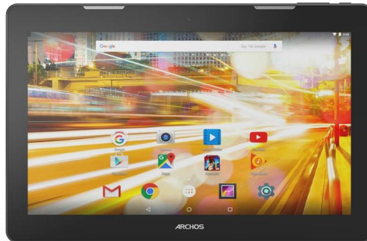
Als Herzstück des Tablets schlägt eine Octa-Core Rockchip RK3368 CPU mit 1,5 GHz. Den Prozessor kombiniert ARCHOS mit einem PowerVR SGX6110 Grafikprozessor – optimal für coole 3D-Games und 4K-Videos.
