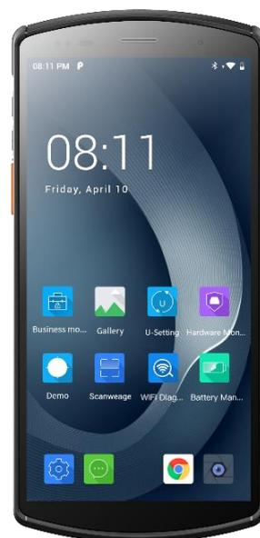
Enfin, le terminal Fieldbook F57G2 conserve les principales caractéristiques ayant fait le succès de son aîné avec une étanchéité à l'eau et la poussière IP65, une vitre de protection en verre trempé et une résistance aux chocs, vibrations et chutes jusqu'à 1.5m de haut.
